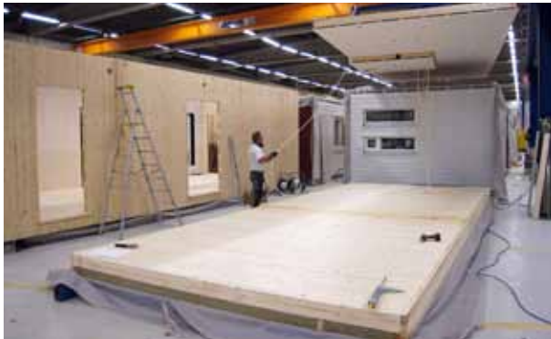
Figur 19 Tillverkning av volymelement med bärande KL-skivor.
