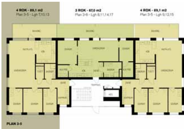
Figur 11 Exempel på planlösning för ett hus byggt med panelement, Älvsbacka Strand.
